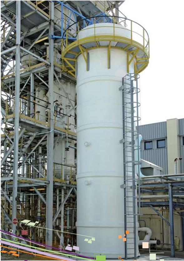
Extrapolation du réacteur Fischer-Tropsch : maquette froide de grande taille (diamètre 3 m, hauteur 15 m) mise en œuvre pour les études et la validation hydrodynamiques.
