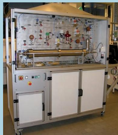
Installation permettant de mesurer la perméabilité aux gaz de tubes polymères (hydrogène, mélange méthane/hydrogène).
