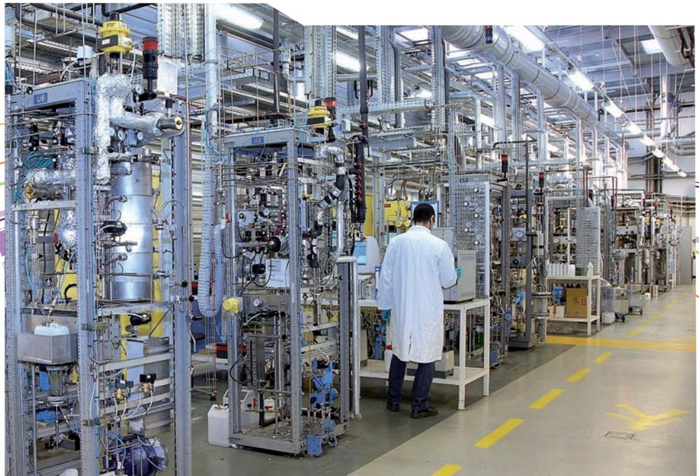
*L'IFP dispose d'une grande diversité d'équipements et de moyens d'essais ; parmi eux, des unités pilotes sont destinées à tester, avant leur extrapolation industrielle, les procédés permettant de produire carburants et biocarburants.*
