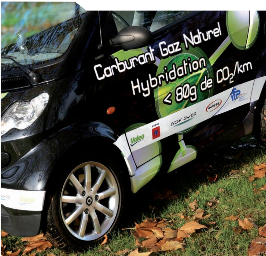
La Smart Vehgan, développée par l'IFP en partenariat avec l'ADEME, GDF Suez, l'Inrets et Valeo, cumule les avantages de l'hybridation à ceux de l'utilisation d'un carburant à faible teneur en carbone, le gaz naturel.
