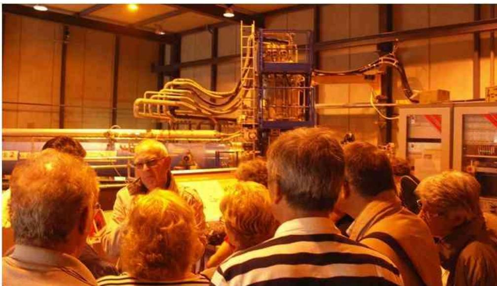
Le bruit est lié au fonctionnement du très gros électroaimant qui crée le champ magnétique nécessaire. Pour l'instant, les axions n'ont pas été découverts. En sortant de ce laboratoire, nous ne pouvons que remarquer d'énormes réservoirs d'hélium (He), cet hélium est utilisé comme fluide cryogénique pour abaisser la température des circuits électriques des électroaimants et rendre ces circuits supraconducteurs.
